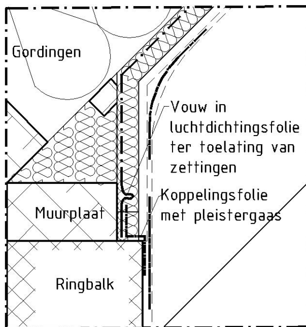
Detail 22: Luchtdichting aansluiting gevel-dak traditionele timmer
