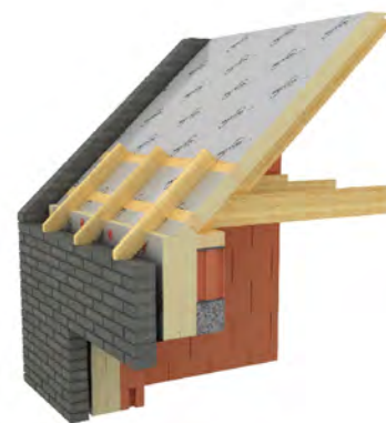
Figuur 3: kepers ter bevestiging van de goot (bron : www.massiefpassief.be )
