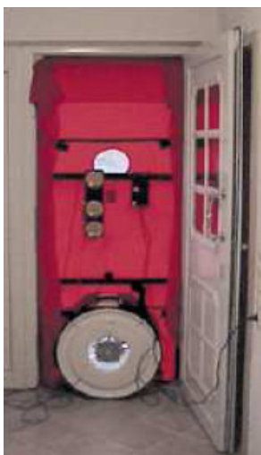
Figuur 2.1: Blower-door test
