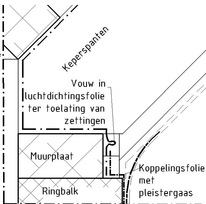
Detail 23: Luchtdichting aansluiting gevel-dak keperspanten
