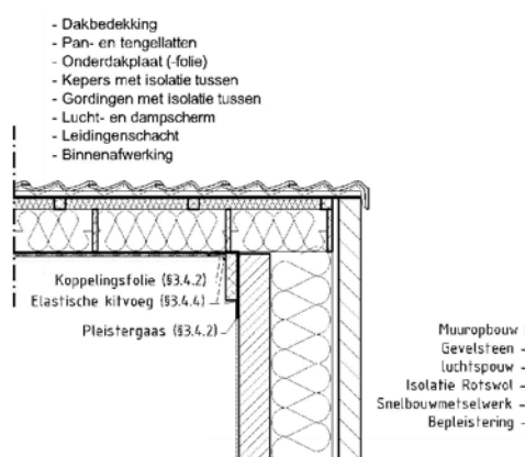
Detail 20: Kopgevel aansluiting gevel-dak traditionele timmer
