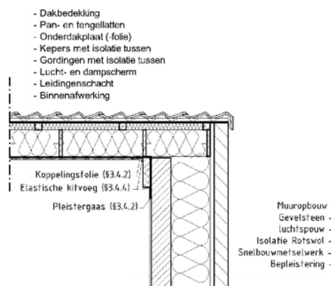
Detail 26: Dwarse aansluiting gevel-dak doorlopende gordingen
